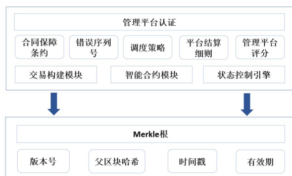
图3 电子合同的数据结构
